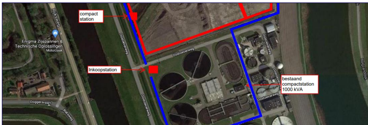
Figuur 21 | Aanwezige compactstations en inkoopstation (Bron: HHNK)
