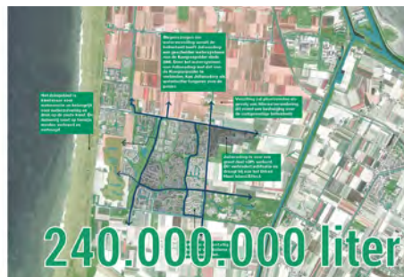
Een opslag volume van 240.000.000 liter water kan aan de Koegraspolder worden toegevoegd door de bestaande stedelijk blauwe structuur te koppelen aan het watersysteem van de polder.
