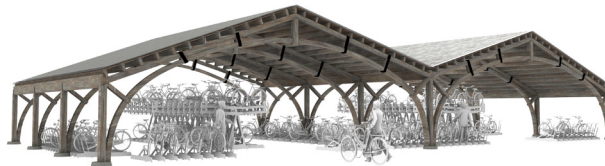
04 draagconstructie met houten Emy-spanten
