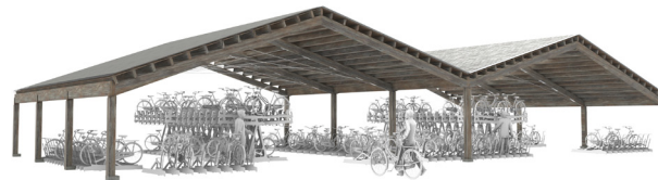
02 draagconstructie met alleen houten spanten en staalnet
