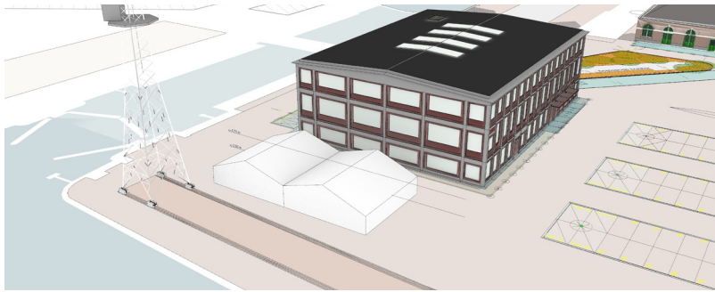
Dubbele dwarskap met hangende schouders, goothoogte op 2,5m
