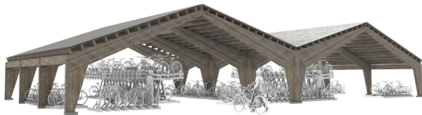
05 draagconstructie met houten glulam spanten
