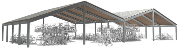
01 draagconstructie met standaard stalen profielen, 5 spanten
