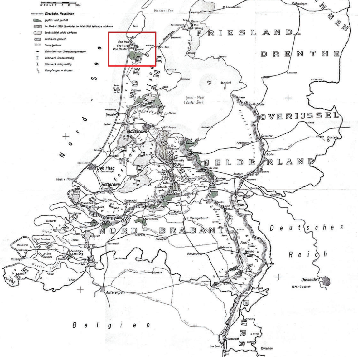
Afb. 4.5. Duitse kaart uit 1940 van de waterhindernissen in Nederland. In rood de verdedigingswerken rond Den Helder, met onder andere de Stelling van Den Helder, en binnen het rode kader, in groen, het inundatiegebied rond Callantsoog en Julianadorp (bron: Stichting Menno van Coehoorn/Kleijn 2004, 4)
