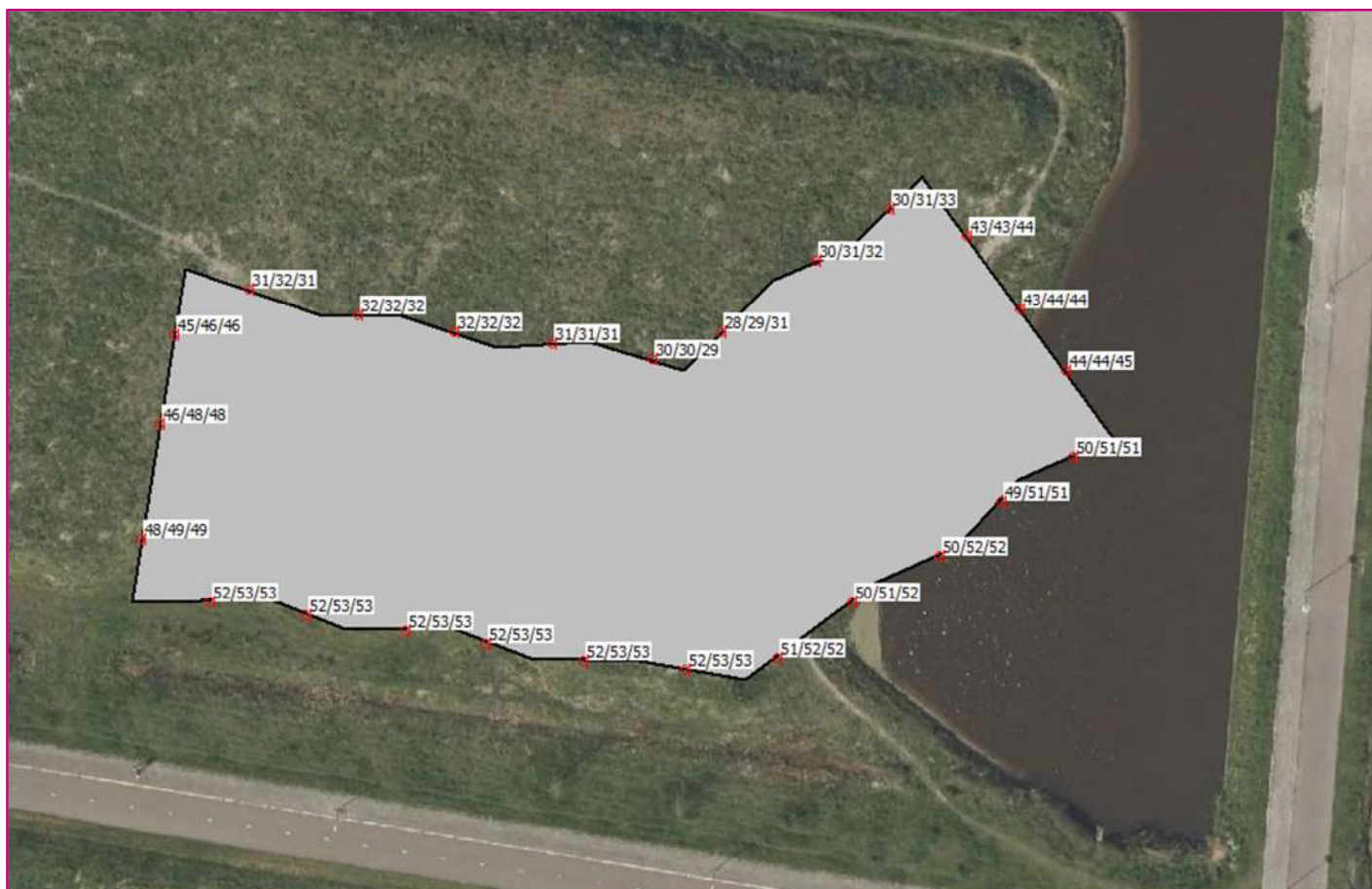
Afbeelding 7: Resultaten (in L_{den} ) na toepassing van SMA NL 8 G+ op de Zuiderhaaks tussen Akkerbouwstraat en Landbouwstraat
